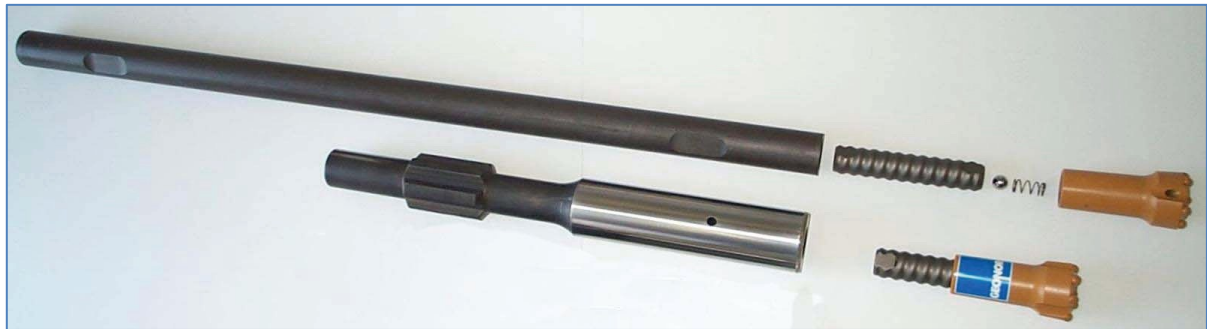
Mynd 6-17 Borstöng 44x2000mm R-32, nipill, kúla, gormur, oddur 57mm R-32(norsk) síðan slagstykki og nipill skrúfaður í odd.
