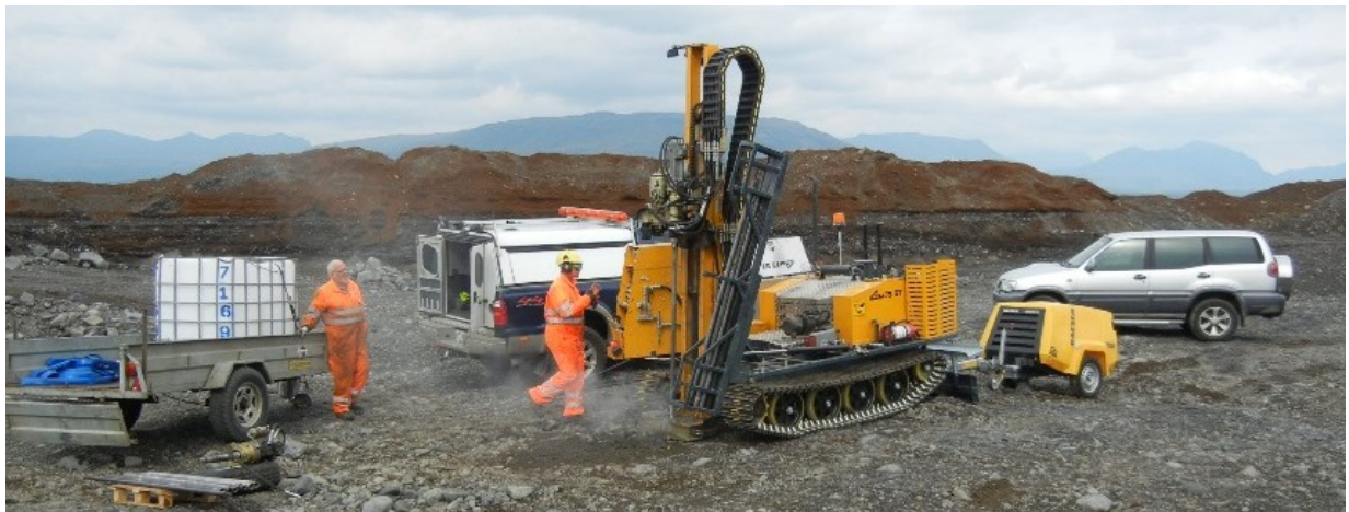
Mynd 6-8. Nýr borvagn Vegagerðarinnar frá 2012, borar bæði í berg og blautt, með í úthaldinu er yfirleitt loftþessa og vatnstankur.
