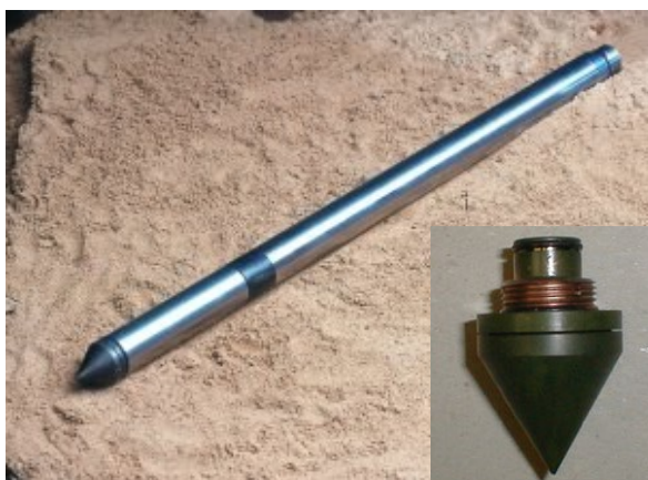
Mynd 6-21 CPT – borstöng með minnikanna, oddur.
