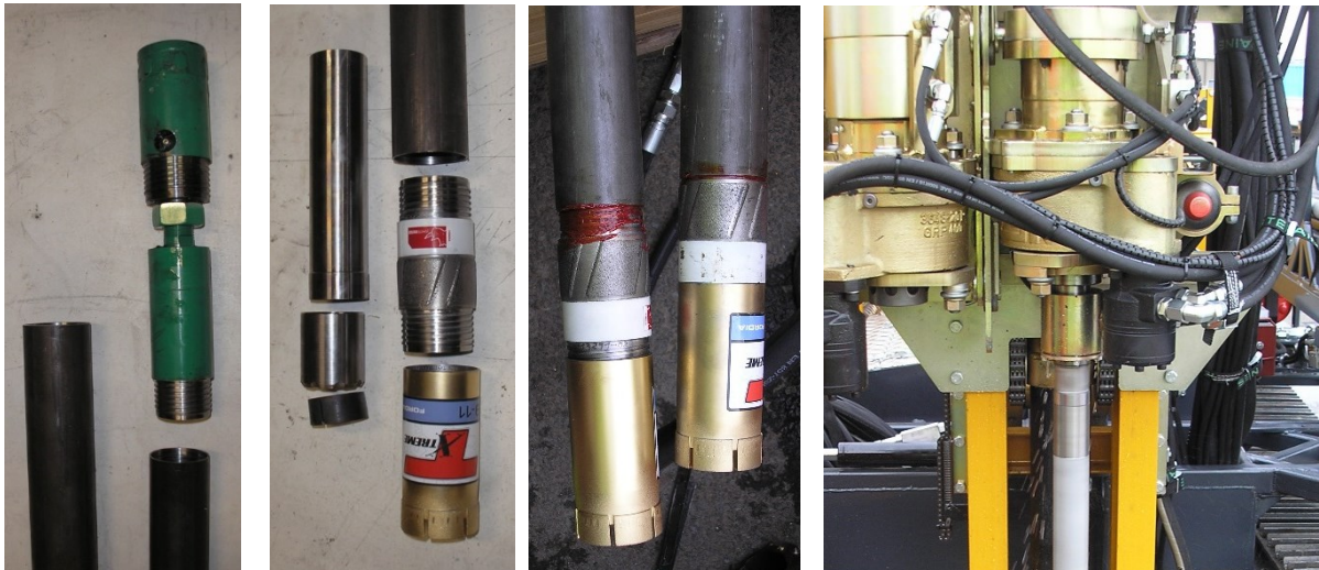
Mynd 6-24 Búnaður fyrir kjarnaborun – toppstíkið, borstangir, króna og innri hólkar.
